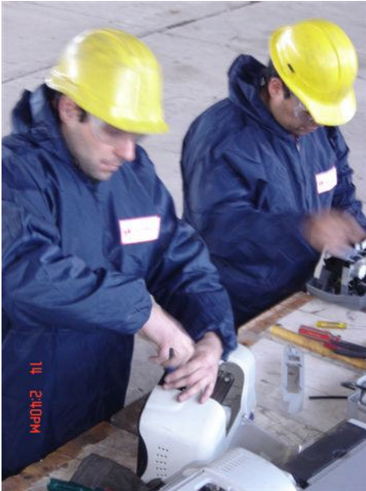
Fotos: Detalle del proceso de desmontaje manual y protecciones de operarios para la seguridad personal
